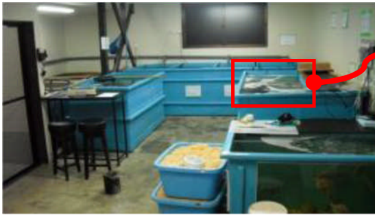
▲浄化槽 スーパースोलをネットに入れ 水面に設置
