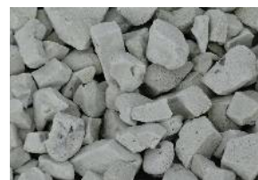
転圧前 (敷き均し・巻き出し)
